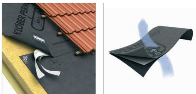
Permo® light SK<sup>2</sup> ha due nastri acrilici adesivi laterali. L'incollaggio dei due nastri crea una giunzione sicura contro il passaggio dell'aria e del vento riducendo le dispersioni termiche.
